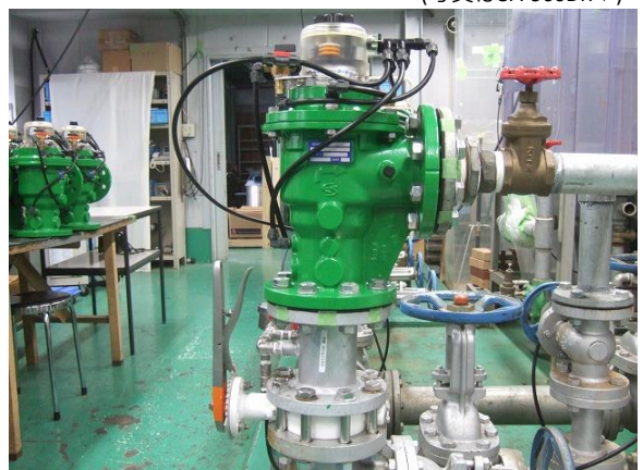
②様々な仕様、機種に合わせて1台ずつ作動検査を行っています!!
