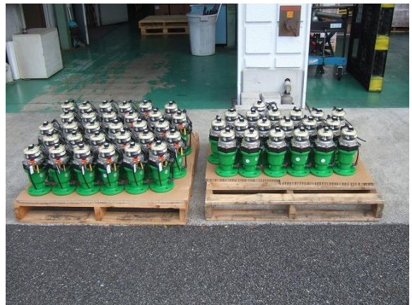
③検査が終わり、梱包待ちのバルブたち。。(写真は2AF-900Dと2AF-900DRです!!)
