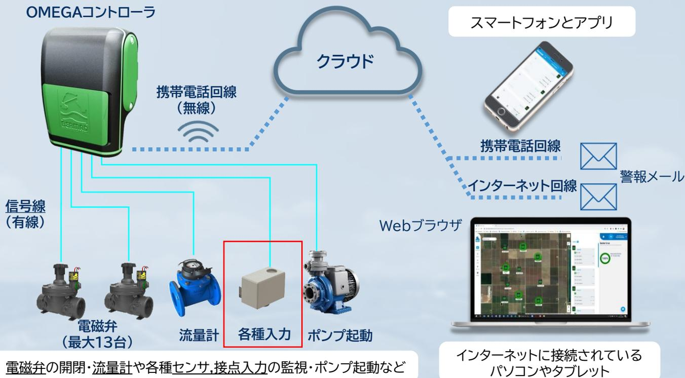
電磁弁の操作や流量確認などの基本的な機能に加え、接点入力監視機能をご利用いただけるようになりました。
