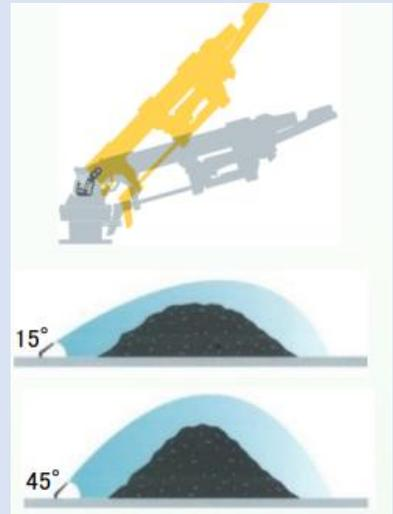
当社のレインガンは自動ブレーキシステムとデフレクター動作によって手前から散水範囲全域に渡ってカーテンの様に均一に散水できます。
